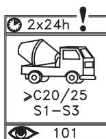
Symbolen visar härdningstid för betong och betongkvalite. Förklaring av olika betongkvalite se ritning 101.
