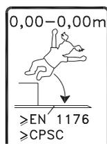
Este símbolo muestra la altura de caída del componente. La capacidad amortiguadora debe ajustarse a las disposiciones de la norma.
